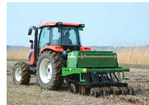
▲グレートプレーンズ3P606NTによる水稻乾田直播
