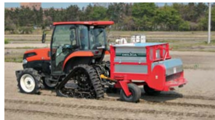
▲マニアスプレッド(けん引式)：堆肥を効率よく均一に散布
