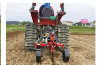
▲耕盤破砕施工(サブソイラ装着)
