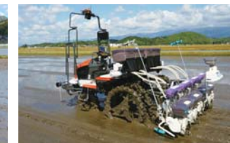
▲アグリロボ田植機NW8SA-PF(無人仕様)による鉄コーティング直播
