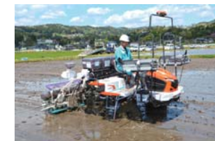
▲GS田植機NW8S-F-GSによる鉄コーティング直播
