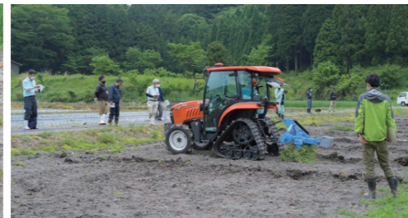
▲5月26日に行われたカットブレイカーによる排水対策機械実演会
