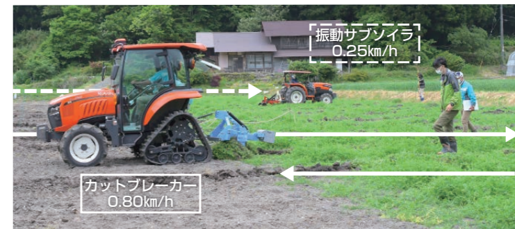
▲カットブレーカーおよび振動サブソイラ施工の様子(5月27日)
