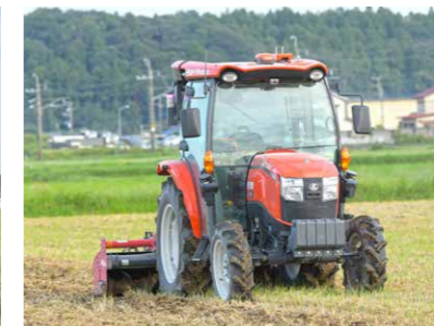
▲アグリロボコンバインとの同時に、無人で耕うん作業を行うアグリロボトラクタSL60A
