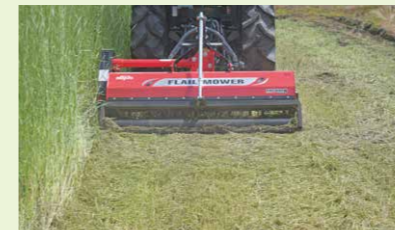
▲アップカットの高速回転で長いライムギを細かく切断
