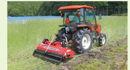
▲直進アシスト機能付トラクタSL350GSに装着されたフレールモアFNC1602R
