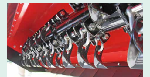
▲イチョウ型爪:イチョウ形爪は地面に対して水平で、刃先が広く刈跡が平らにきれいに仕上がります。
