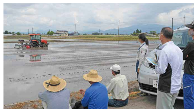
▲GSトラクタ(SL600GS)による代かき同時播種作業の実演。GS機能によって、高精度で安定的な湛水直播が可能になることを確認！
