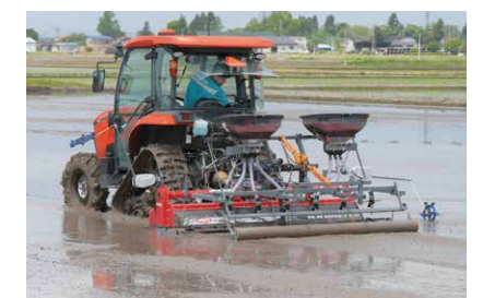
▲GS機能(自動操舵)なので、運転はトラクタに任せて、後ろを振り返り播種状況を確認できる
