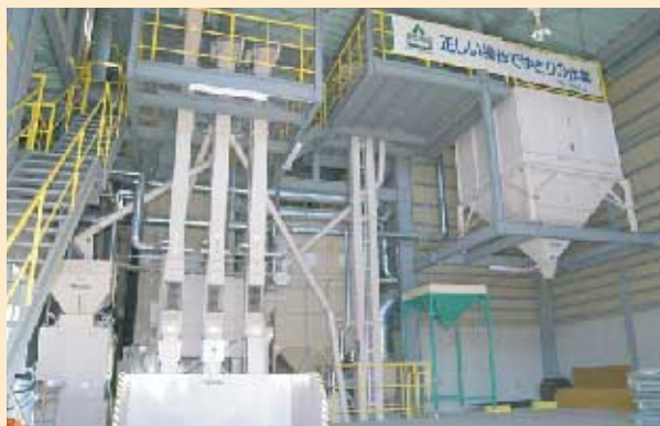
▲高性能遠赤外線式乾燥機が備えられている
